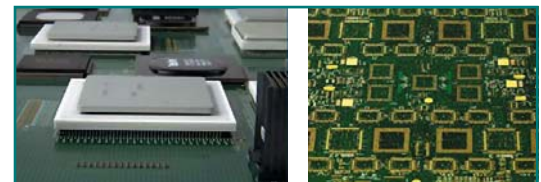
Рис. 1. Малогабаритные элементы на печатной плате и внешний вид МПП
