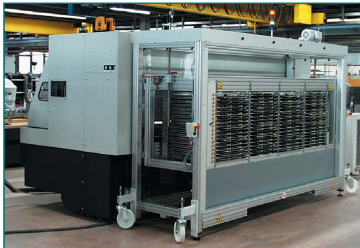
Рис. 22. Автоматический загрузчик/разгрузчик с буфером на 9 или 18 позиций на каждую станцию
