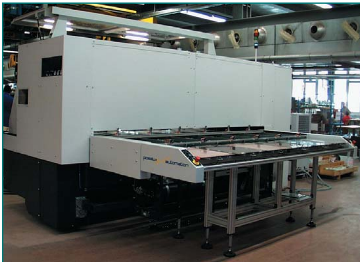
Рис. 21. Автоматический загрузчик/разгрузчик с одиночным буфером
